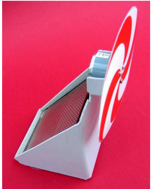
Solarventilator 2, mit Solarzelle
